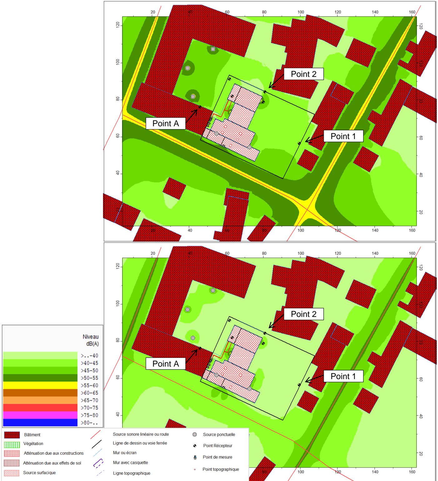
Figure 7 : Modélisation informatique des niveaux ambiants futurs diurnes (haut) et nocturnes (bas), h = 2m – Sans traitement
